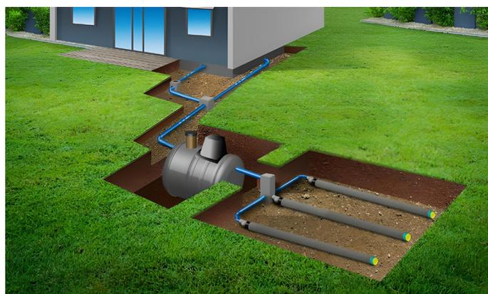
**INFILTRATUBE, la solution pour infiltration des eaux claires après système de traitement agréé**
